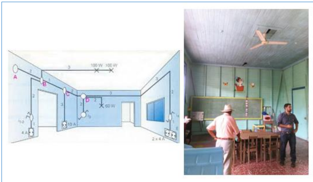
Figure 4 Ilustración sistema eléctrico de un aula (Izquierda) y aula de la escuela Andrés Briceno
